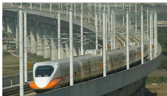
Slika 6. Pruga za velike brzine u Tajvanu sa velikim brojem objekata i sa najvećom emisijom CO 2 od 180 t po km pruge [17]
