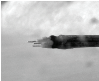
Slika 12.- Senzor za merenje elektroprovodnosti, sa tri elektrode [17].
