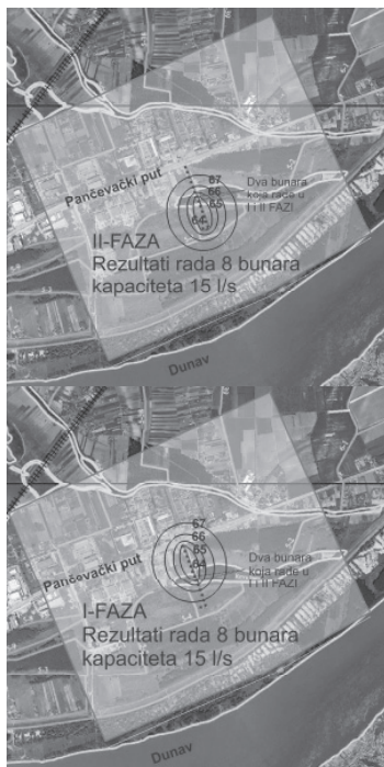
Slika 13.- Sniženi nivo podzemne vode kao rezultat rada drenažnog sistema
