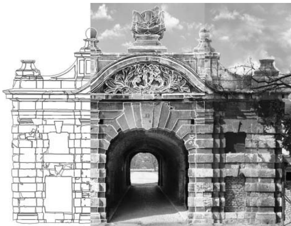
Slika 12. - Ilustracija izrade 3D modela i true ortofotoa na primeru Kapije Karla IV u Donjem Kalemegdanu
