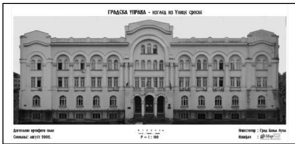
Slika 6. - Štampana forma digitalnog ortofotoa fasade na pri- meru Gradske uprave u Banja Luci
