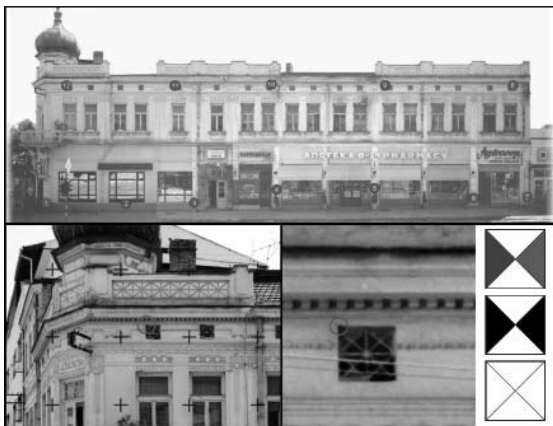
Slika 5. - Izbor orijentacionih tačaka na primeru objekta na Trgu vojvode Radomira Putnika u Kragujevcu i oblik i izgled markica-signala
