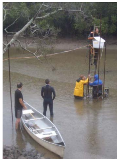
Slika 4. Upotreba ADA uređaja na malom estuaru u Australiji, radi procene turbulentnih statistika vodotoka (Chanson, 2008).
