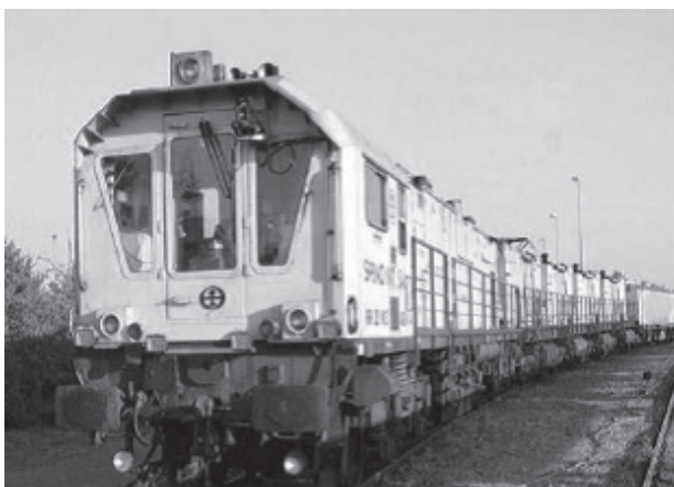
Slika 8. Izgled brusnog vozila sa EC uređajima: u jednom smeru vozilo brusi, a u povratnoj vožnji vrši EC defektoskopiju
