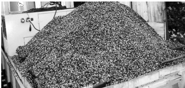
Slika 13. Strugotina nastala glodanjem šinskog čelika [25]
