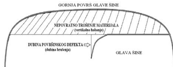
Slika 14. Razvoj površinskog defekta i vertikalnog habanja na glavi šine
