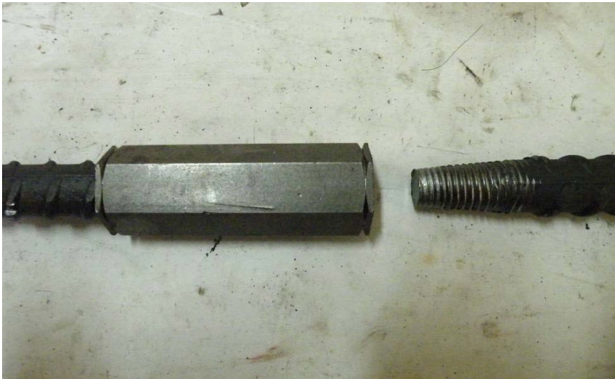
Slika 3 - Detalj loma uzorka koji je nastupio po koničnom navoju – "izvlačenjem" armaturne šipke iz mehaničke spojnice
