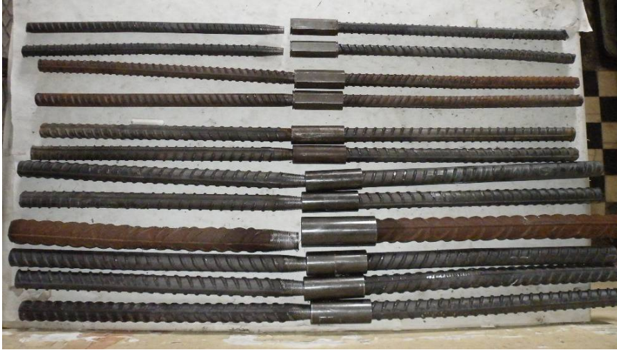
Slika 2 - Uzorci (epruvete) različitih prečnika u okviru kojih su za spajanje armaturnih šipki primenjene odgovarajuće spojnice sistema Lenton (nakon ispitivanja na zatezanje)
