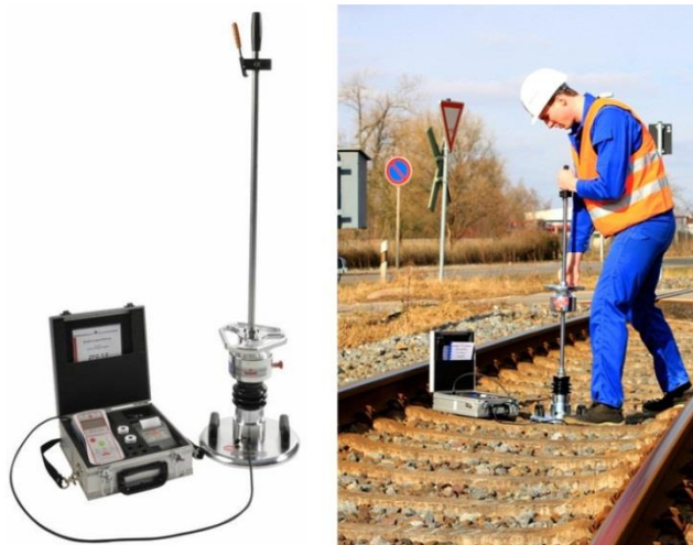
Слика 6.1 Испитивање угиба прагова применом опита са падајућим теретом [86]
