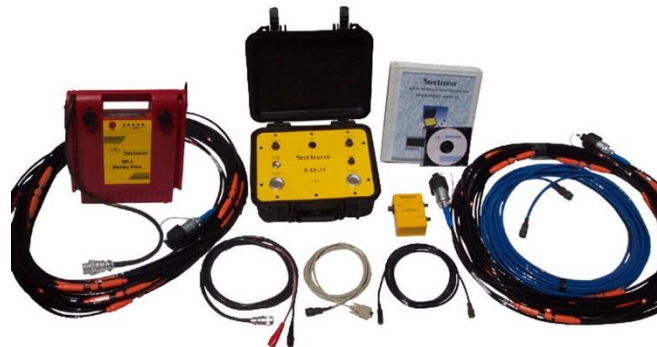
Слика 7.5 Сеизмометријски аквизициони систем RAS-24 [98]
