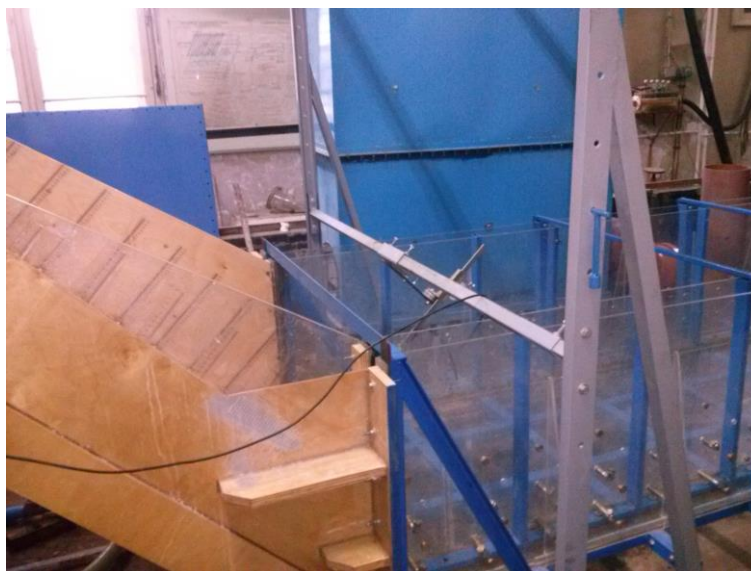
Слика 4.9 Метални рам за постављање мерне опреме
