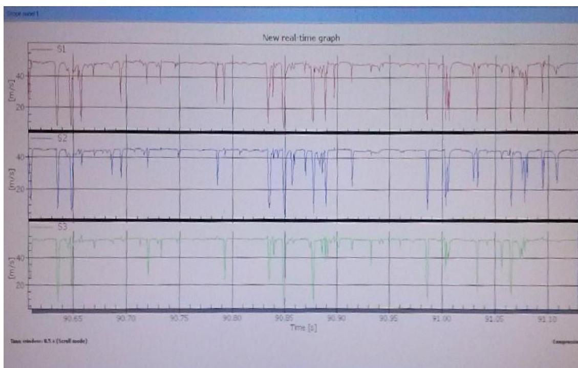
Слика 2.2 Дијаграм пулзација притисака у умирујућем базену
