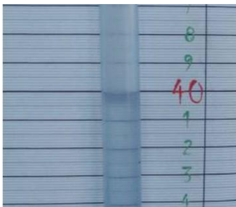
Слика 4.17 Лењир и пијезометарска цев на резервоару мерне инсталације [19]
