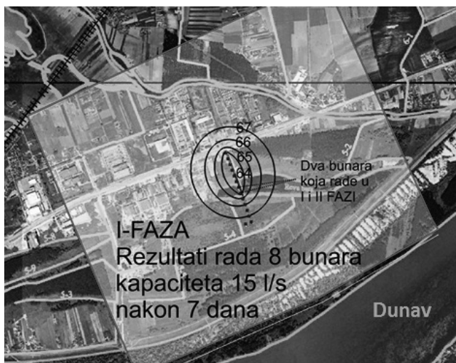
Slika 3 Shematski prikaz rezultata hidrauličkog proračuna I faze rada drenažnog sistema nakon 7 dana od početka rada sistema
