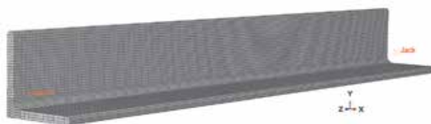
Slika 5. Geometrija FE modela i rubni uvjeti
