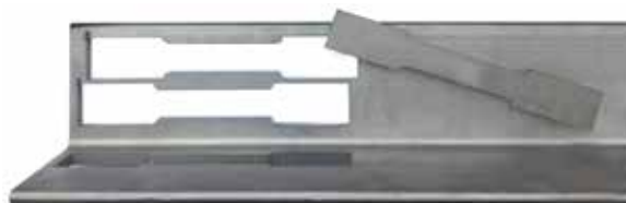
Slika 2. Položaj vađenja uzoraka iz toplo valjanog kutnika
