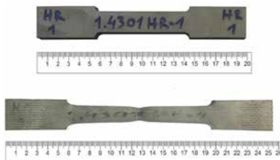
Slika 3. Uzorci od nehrđajućeg čelika prije i poslije ispitivanja
