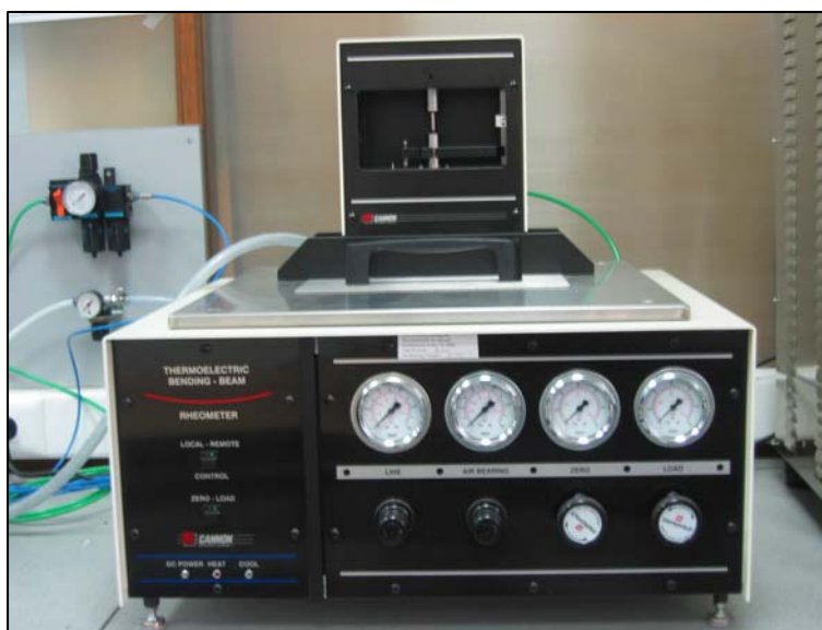
Слика 9. Реометар за савијање гредица на ниским температурама
