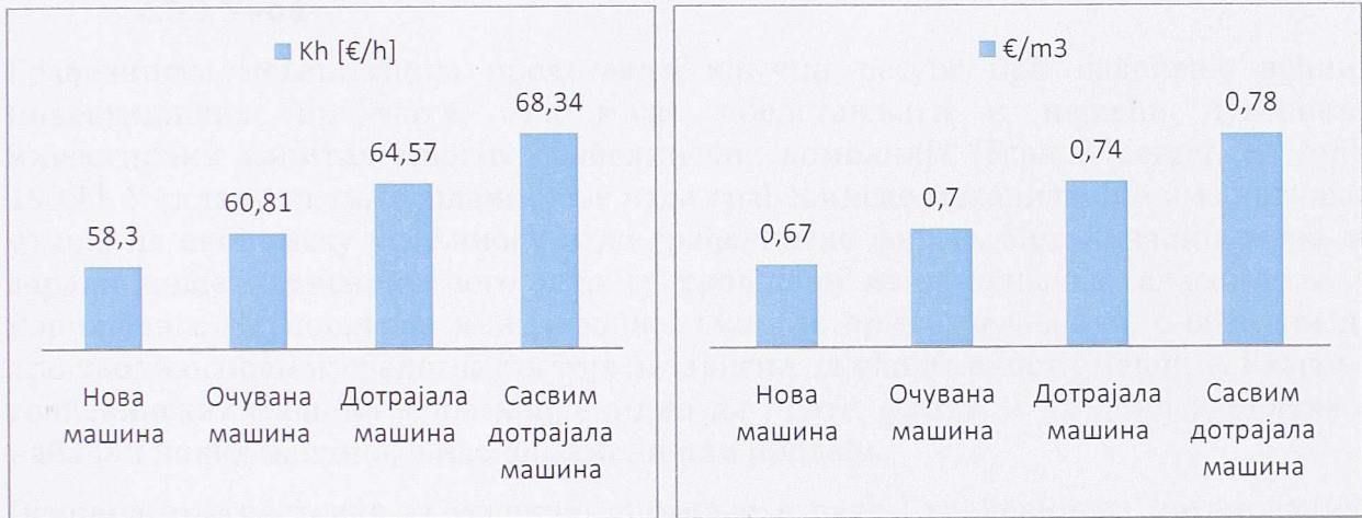
Слика 2.14 - Утицај техничке дотрајалости машине на коштање радног сата (лево) и на коштање ископа по јединици мере (десно) за багер САТ 320
