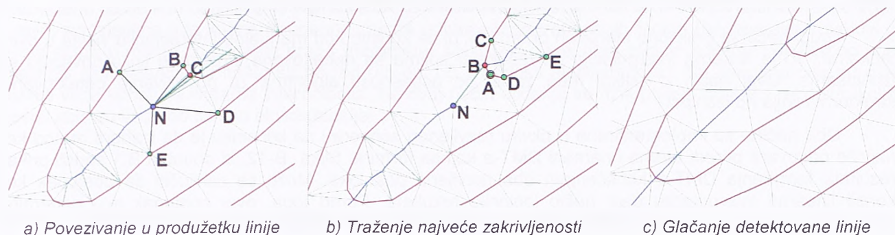
Slika 4-21 : Povezivanje (produžavanje) segmenata detektovanih strukturnih linija do izohipsi
