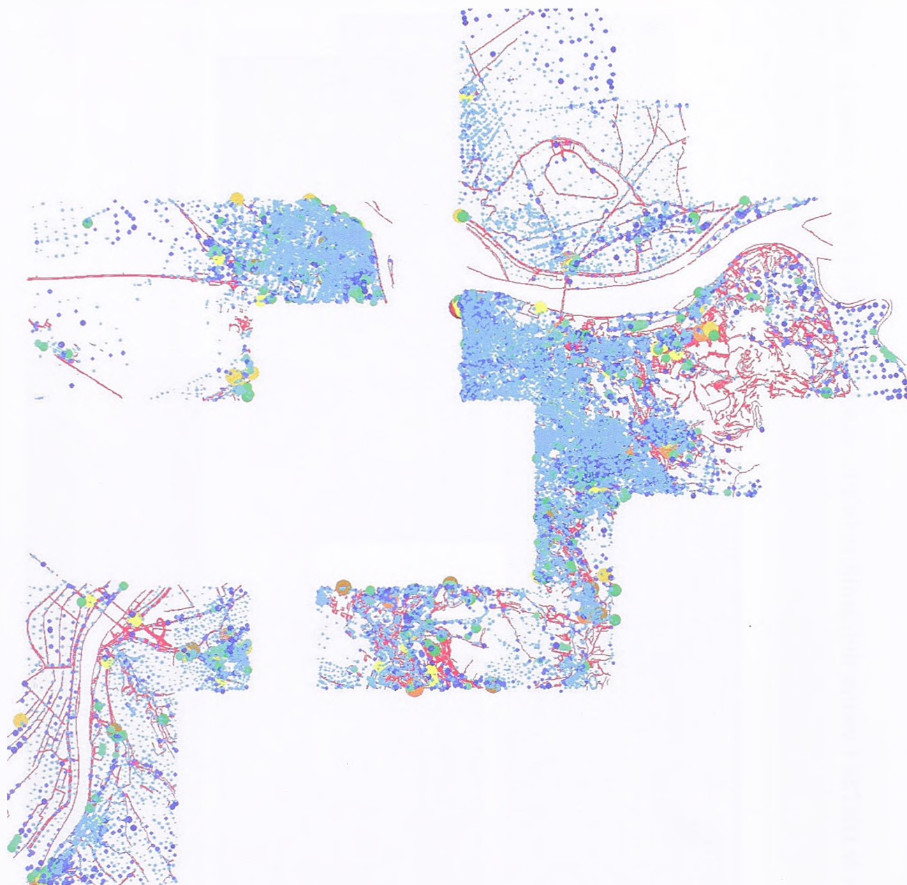
Slika E-19 : Greške upoređenja visina tačaka poligonske mreže grada Beograda i visina interpolovanih iz DTK5 DMT-a za područje Beograda (centar, Borča, Kumodraž, Ostružnica i Zemun) – tačke poligonske mreže sa grubim greškama su odstranjene(Izveštaj E-33)
