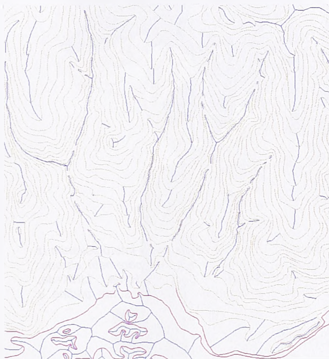
c) Detalj DMT25 sa detektovanim strukturnim linijama
