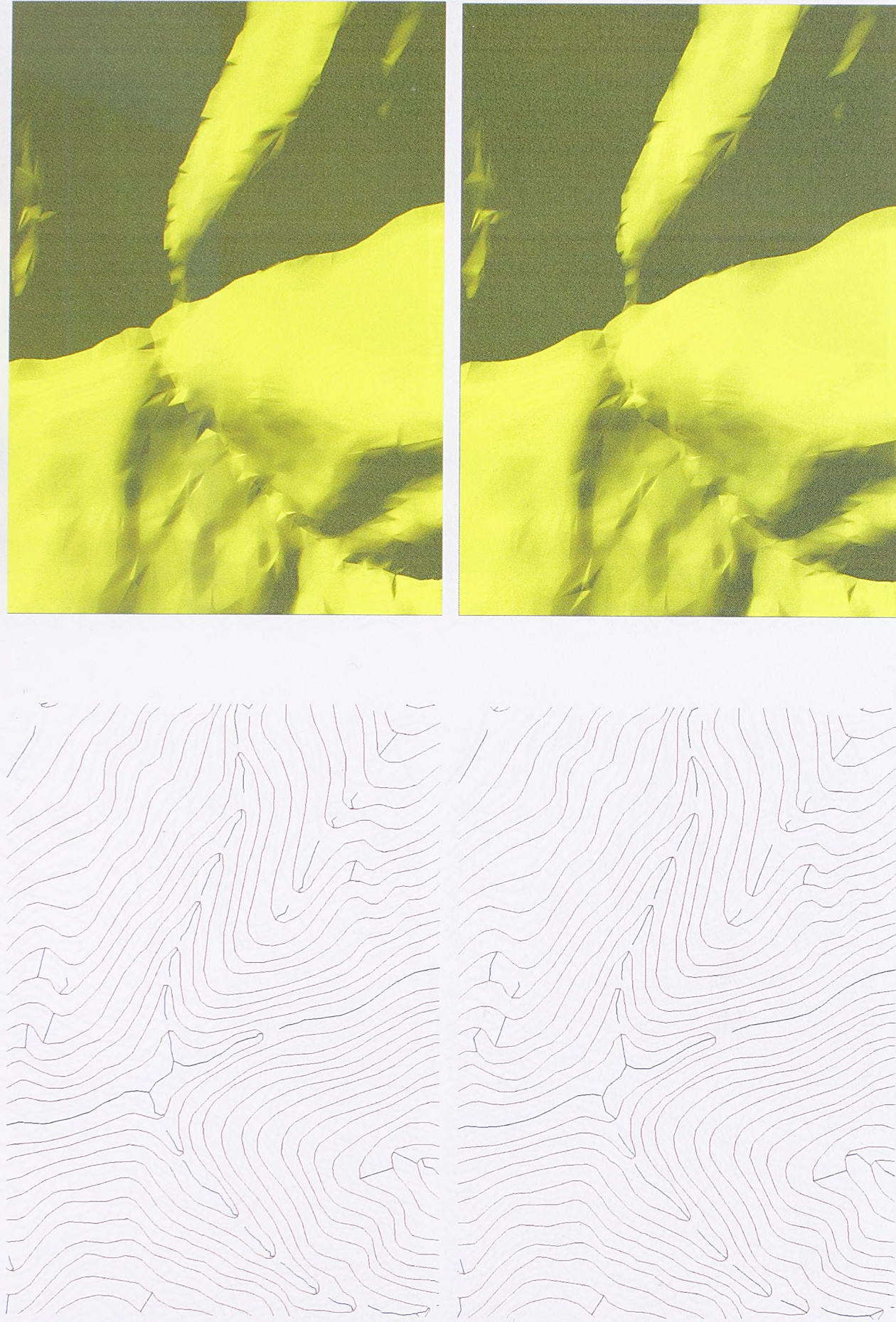
Slika B-10 : Prikaz rezultata dobijenih primenom algoritma EM bez glačanja detektovanih linija (gore) i sa glačanjem (dole)
