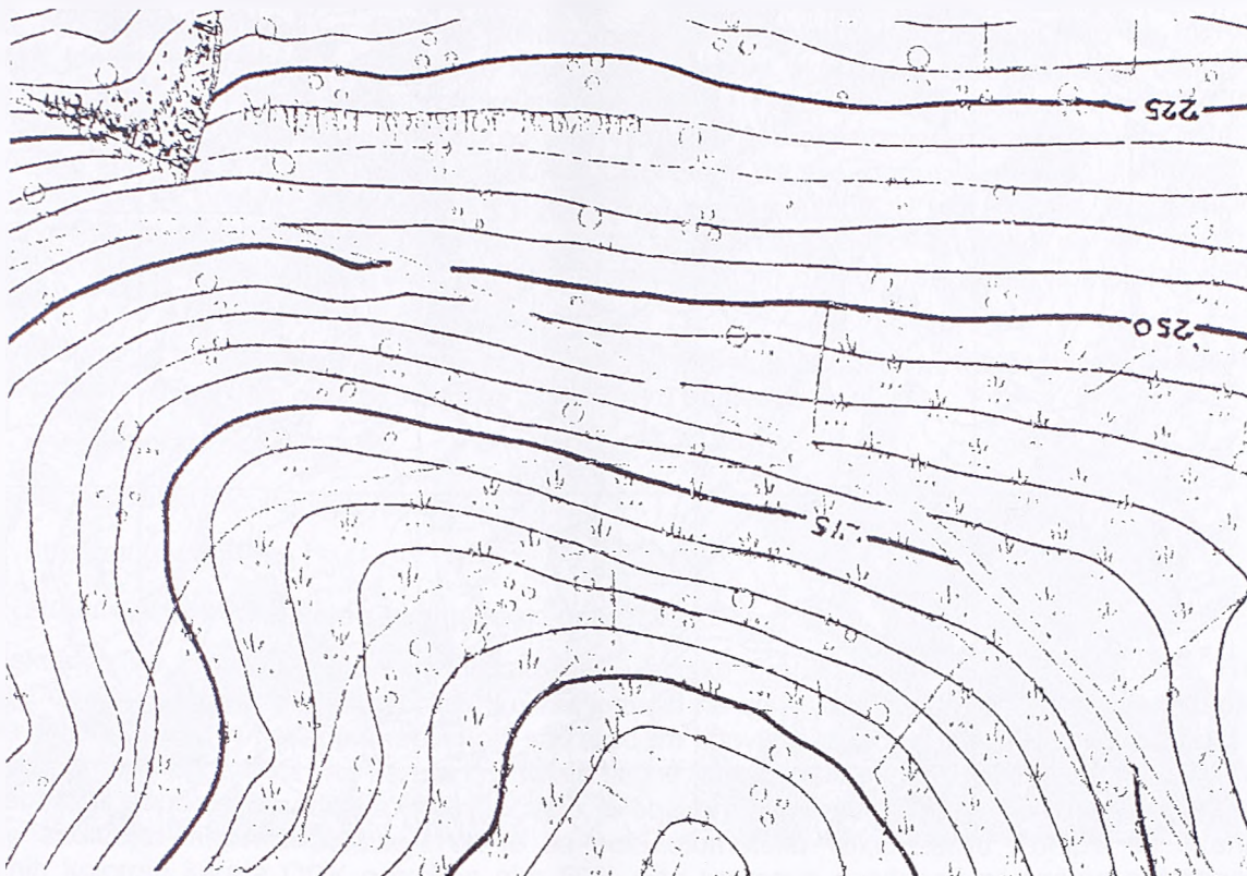
Slika 5-10: Detalj kolorne karte ODK 1:5000 koja je skenirana u koloru (24 bita po pikselu, 400 DPI), nakon separacije sadržaja koji odgovara sepija tonovima i pretvaranja u sliku sa 1 bitom po pikselu
