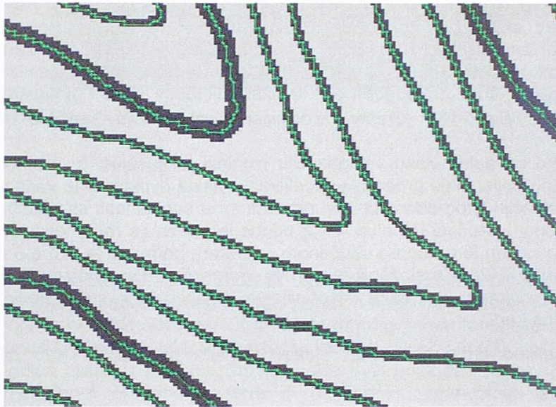
Slika 5-19 : Primer prevelike gustine tačaka za predstavljanje vektorizovane izohipse
