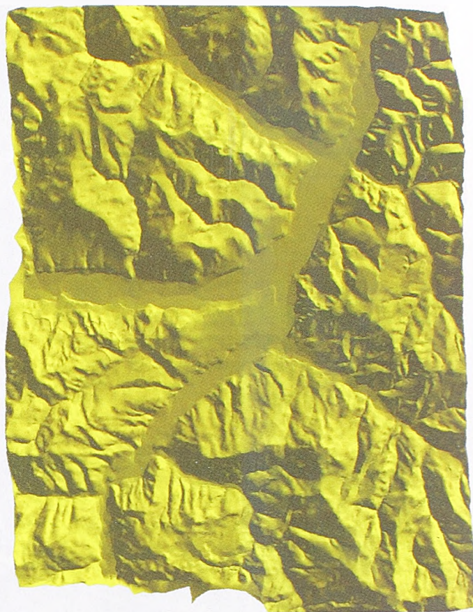
b) Senčeni model rekonstruisane površi terena - 3D prikaz (150542 tačke, 301078 trouglova)
