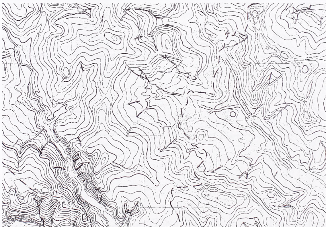
Slika 5-13 : Detalj kolorne karte TK25 koja je skenirana u koloru (24 bita po pikselu, 254 DPI), nakon separacije sadržaja koji odgovara sepija tonovima i pretvaranja u sliku sa 1 bitom po pikselu
