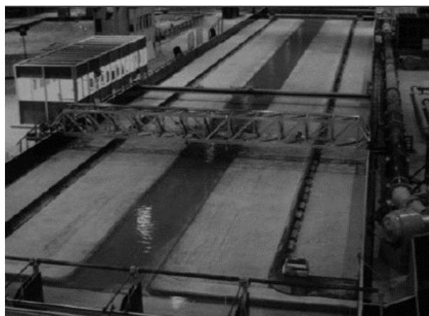
Slika 6. Laboratorijski kanal za ispitivanje tečenja u koritu za veliku vodu [15]
