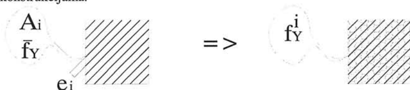
Slika 3.8: Modeliranje prisustva armature zamenjujućom membranom
