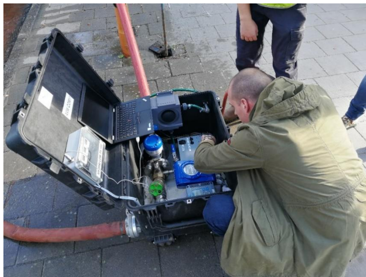
Slika 1. Kofer sa mernom opremom, za merenje protoka, pritiska i mutnoće, pri primeni IJP (Amsterdam, Holandija).
