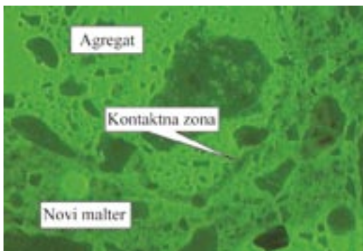
Slika 4. Kontaktna zona između zrna recikliranog agregata i nove cementne paste, optički fluorescentni mikroskop [8]
