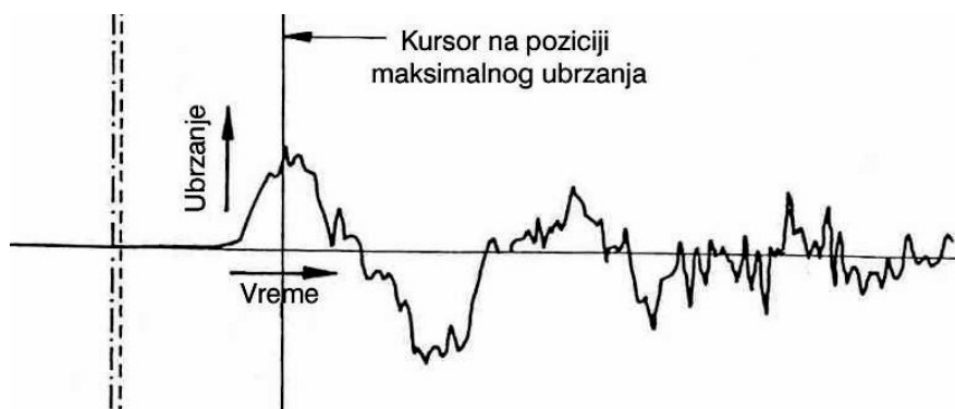
Slika 5 – Tipičan dijagram promene ubrzanja udarne mase tokom vremena
