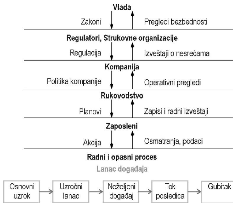
Slika 48. Socio-tehnički sistem uključen u upravljanje rizikom (prema Rasmussen i Svedung, 1997).
