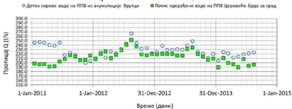
Slika 60. Dotok sirove vode na PPV „Cerovića brdo” i potis sa postojenja ka Užicu (podaci „Vodovod Užice”)
