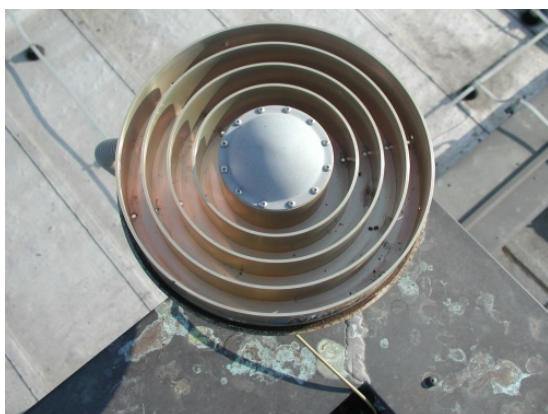
Slika 7.1.2 – Pogled odozgo na antenu ASH701945C_M (lijevo) i sa strane (desno) smještene na krovu zgrade INRIM (Istituto Nazionale di Ricerca Metrologica) kompleksa u Torinu (izvor: http://www.epncb.oma.be/networkdata/siteinfo4onestation.php?station=IENG00ITA )
