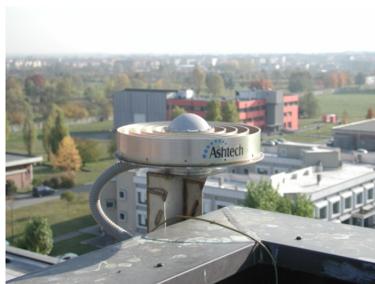
Slika 7.1.2 – Pogled odozgo na antenu ASH701945C_M (lijevo) i sa strane (desno) smještene na krovu zgrade INRIM (Istituto Nazionale di Ricerca Metrologica) kompleksa u Torinu (izvor: http://www.epncb.oma.be/networkdata/siteinfo4onestation.php?station=IENG00ITA )
