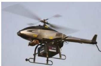
Slika 2.6: Bespilotna letelica – dron sa LiDAR opremom [272].
