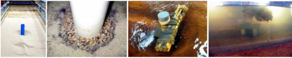
Slika 4.48: Laboratorijska ispitivanja lokalne erozije oko mostovskih stubova; sleva na desno: veličina i oblik eroziona jame oko cilindričnog stuba, armirajući sloj oko stuba, uticaj naplava (granja i balvana) na potkopavanje mostovskog stuba [47, 277].
