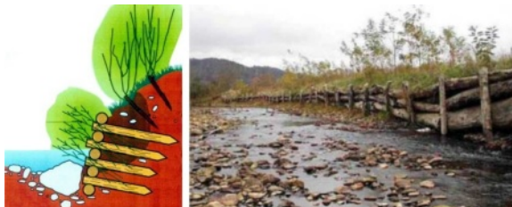
Slika 5.9: Primeri korišćenja drvene građe u izradi obaloutvrda [287, 210].
