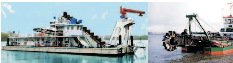
Slika 4.66: Primeri mehaničkih bagera; levo: bager-vedričar; desno: bager sa rotacionom zahvatnom glavom [276].
