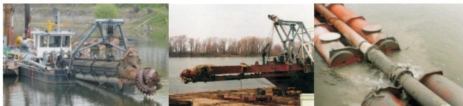
Slika 4.68: Primeri hidrauličkih bagera; levo: rotacioni sekač na vrhu usisne cevi [276]; sredina: bager refuler „Jadar” (Plovput-Beograd); desno: plutajući cevovod.
