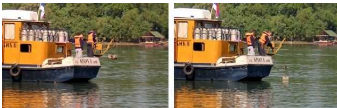
Slika 2.17: Zahvatanje materijala sa dna reke Save spuštanjem hvatača sa specijalizovanog broda za merenja na rekama Instituta „Jaroslav Černi” [120].
