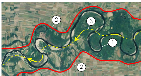
Slika 3.115: Primer hidraulički ispravnog trasiranja nasipa; 1 – glavno korito, 2 – nasipi, 3 – osovina korita za veliku vodu.
