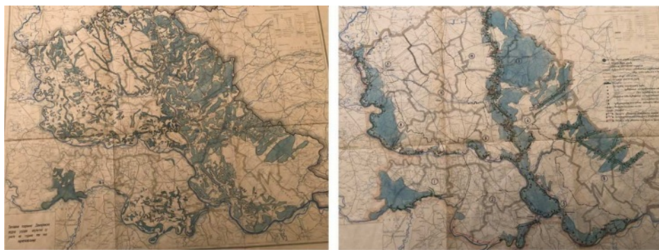
Slika 2.27: Istorijske karte ugroženosti od poplava u Vojvodini iz 1942. godine; levo: pre interventivnih radova; desno: posle izgradnje odbrambenog sistema (arhiva muzeja Hidrosistema Dunav-Tisa-Dunav).
