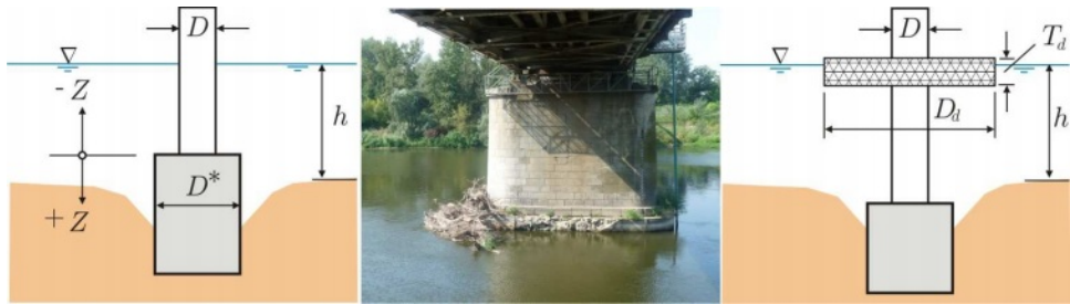
Slika 4.51: Ekvivalentni prečnik stuba i snimak naplava oko stuba mosta na Velikoj Moravi kod Markovca.
