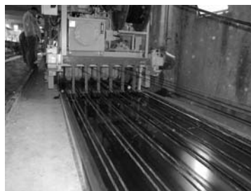
Slika 1. Čelik za prednapinjanje razvučen na stazi
