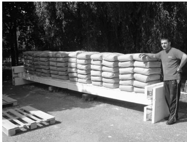
Slika 5. Model superlake StiroFert konstrukcije u fazi opterećivanja
