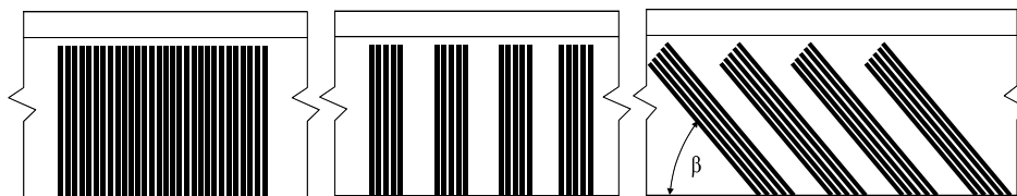
Slika 2. Pojačavanje greda na smicanje platnima i trakama lepljenim vertikalno ili koso
