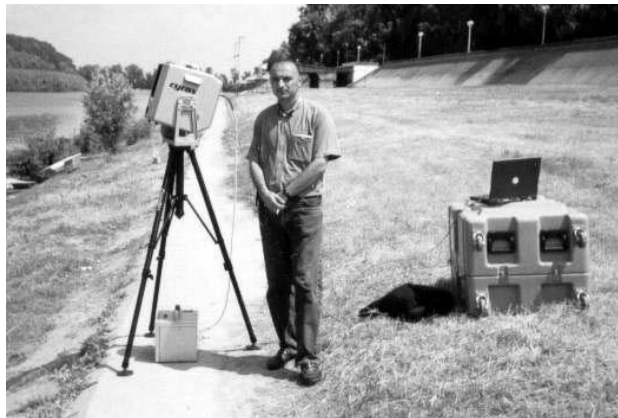
Slika 1. 3D laserski skener Cyrax_2500 u fazi skeniranja mosta
