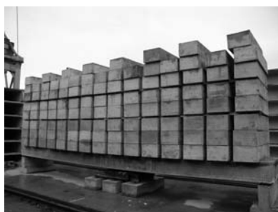
Slika 7. Ispitivanje nosivosti ploče tipa PPV 400-G 45
