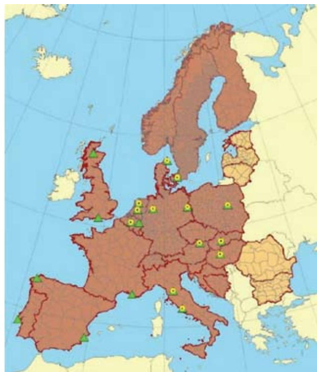
Слика 2. Тачке за реализацију датума EVRS2007 [5] (жути кругови одабране, а зелени троуглови предложене тачке)
