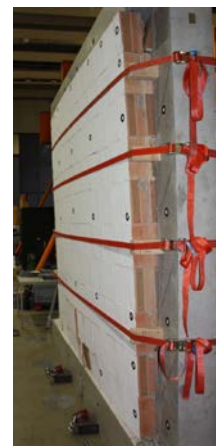
Slika 18. Pomeranja van ravni za tradicionalnu ispunu (BIO) pri simultanom opterećenju (levo) i deformisani uzorak na kraju testa (desno)
