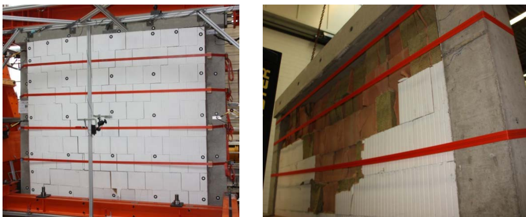
Slika 10. a) Oštećenje spojne strane i b) unutrašnje strane zida na kraju testa
