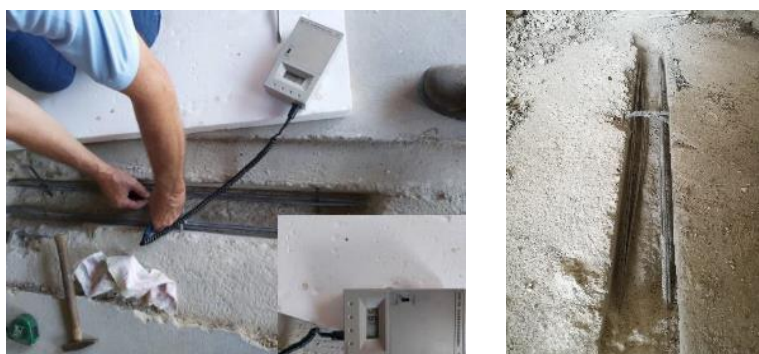
Slika 4 - Merenje frekvencije oscilovanja žice za prednaprezanje (levo) i „labave“ žice za prednaprezanje
