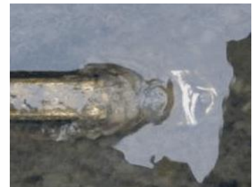
Slika 4. Rezultati preliminarnog ispitivanja rada ADV i EM senzora pod pokrivanom od poroznog nanosa
