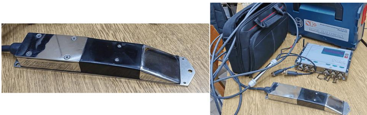
Slika 2. Primer ravnog EM senzora za merenje brzine i dubine, sa prenosnim logerom
