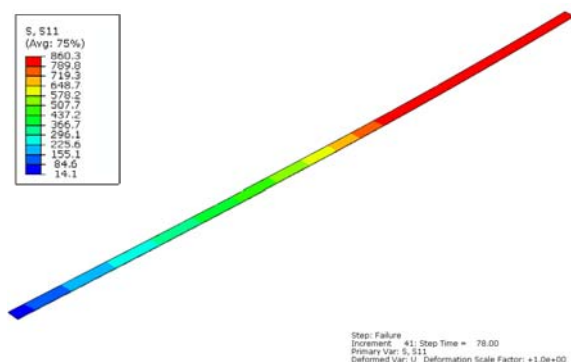
Слика 7. Нормални \sigma_{11} напони (МПа) у карбонској траци при граничном оптерећењу за ојачани носач Серије В
