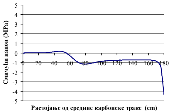
Слика 8. Смичући \tau_{12} напон у лепку дуж линије споја при граничном оптерећењу за ојачани носач Серије В
