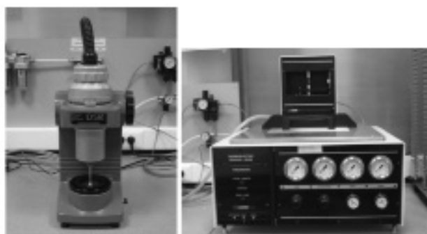
Slika 3.- Oprema za ispitivanje reoloških karakteristika bitumena u Laboratoriji za kolovozne konstrukcije Građevinskog fakulteta
