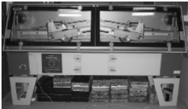
Slika 6.- Mali uređaj za ispitivanje otpornosti na trajnu deformaciju – opit točkom
