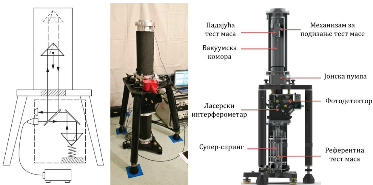
Слика 2.2: Апсолутни гравиметар FG5 (слика је преузета са https://www.nist.gov/ )
