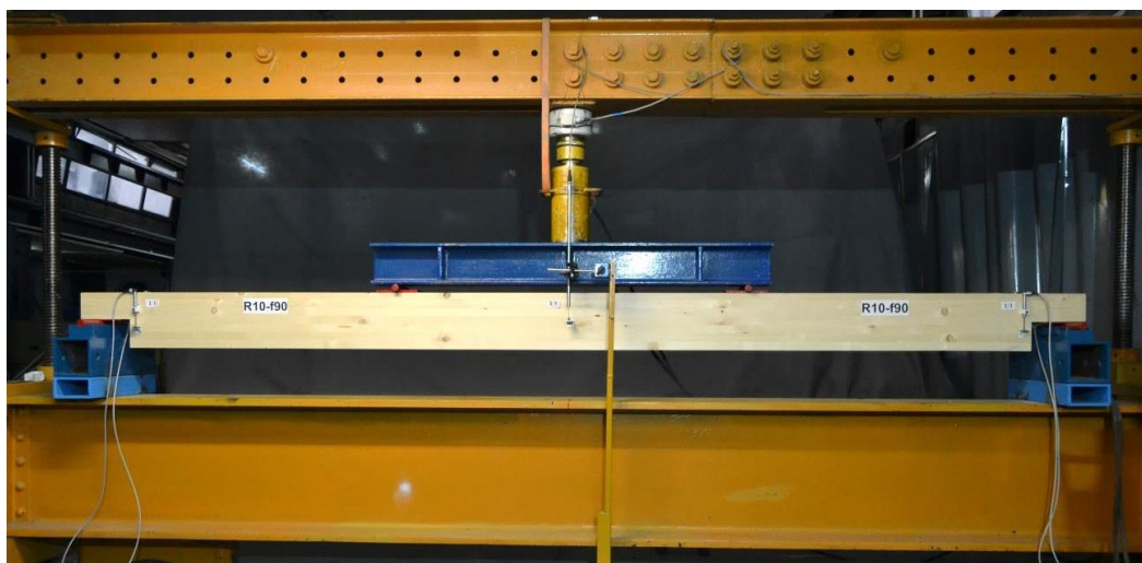
Слика 8. Носач постављен у рам за испитивање
