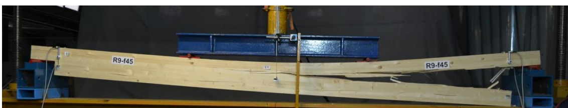
Слика 23. Лом услед смицања носача ојачаних косим GFRP шипкама – Серија R-f45
