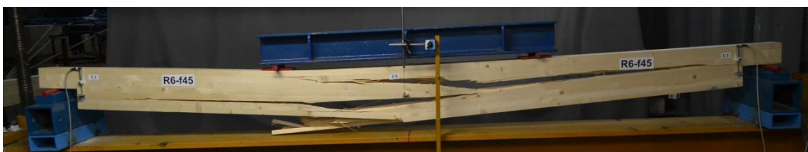
Слика 22. Лом услед савијања носача ојачаних косим GFRP шипкама – Серија R-f45
