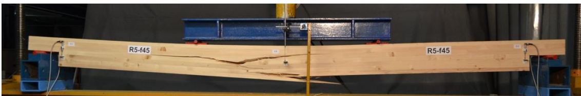
Слика 21. Лом услед савијања носача ојачаних косим GFRP шипкама – Серија R-f45
