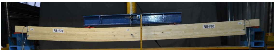
Слика 17. Лом услед смицања носача ојачаних вертикалним GFRP шипкама – Серија R-f90
