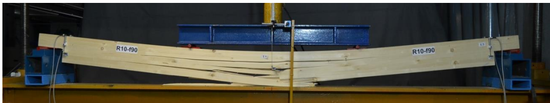
Слика 16. Лом услед савијања носача ојачаних вертикалним GFRP шипкама – Серија R-f90
