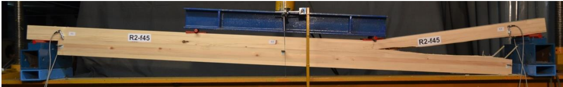
Слика 20. Лом услед смицања носача ојачаних косим GFRP шипкама – Серија R-f45
