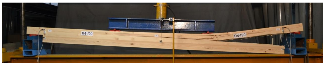
Слика 15. Лом услед смицања носача ојачаних вертикалним GFRP шипкама – Серија R-f90
