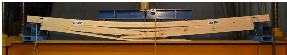
Слика 14. Лом услед савијања носача ојачаних вертикалним GFRP шипкама – Серија R-f90
