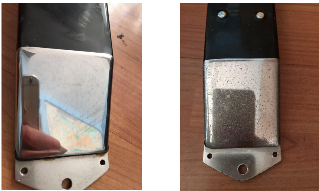
Slika 5. Oštećenje prohrmskog kućišta EM merila protoka nakon intezivnog kišnog oticaja: Levo) Pre merenja, Desno) Posle merenja.
