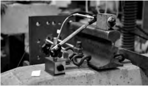
Slika 7. Laboratorijsko ispitivanje sistema KS sa stezaljkom Skl 12 [16]
