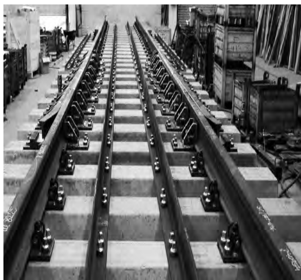
Slika 10. Izgled dilatacione sprave
