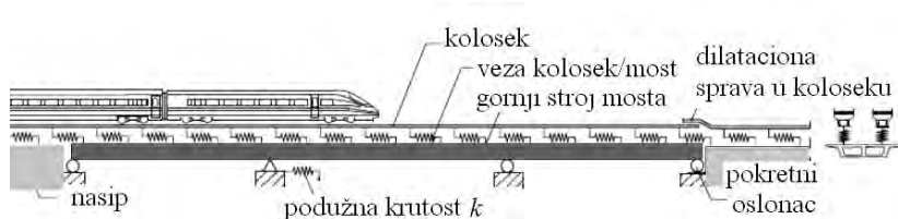
Slika 9. Proračunski model interakcije most/kolosek
