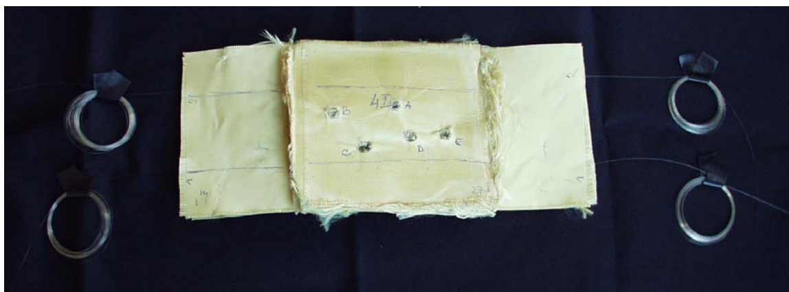
Slika 12. Fotografija uzorka kompozitnog materijala sa ugrađenim OFS nakon pet uzastopnih balističkih ispitivanja Figure 12. Photo of composite material specimen with embedded optical fibres after five consecutive ballistic tests.
