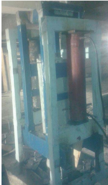
Slika 2: Garnitura za ispitivanje uzoraka s hidrauličnim presama Figure 2: Set for sample testing with hydraulic presses
