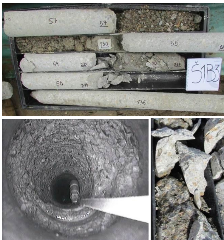
Слика 2. Изглед језгра и зида бушотине Figure 1. Look of the core and wall of the well
