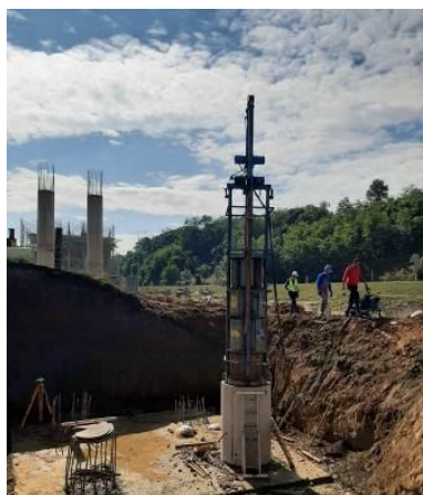
Слика 5. Опрема за динамичко оптерећење шипа Figure 5. Equipment for dynamic load test
