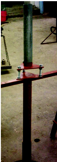
Slika 6. Modifikovani stub-nosač za kišomer PLUVIO. Figure 6. Modified stand tube for the PLUVIO rain gauge
