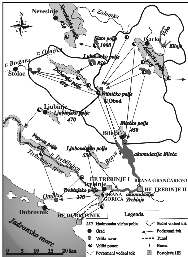
Slika 1. Deo područja Istočne Hercegovine sa osnovnim pravcima podzemnih tokova i slivnim područjima izvorišta reka Bregave i Trebišnjice
