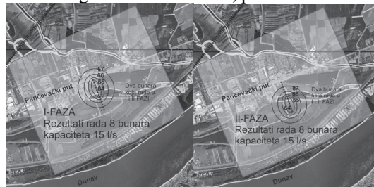
Slika 6. Sniženi nivo podzemne vode kao rezultat rada drenažnog sistema
