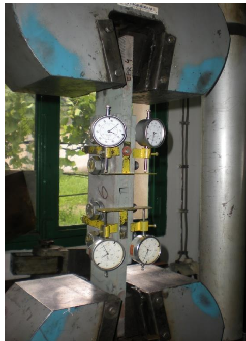
Slika A.2: Određivanje sile trenja
