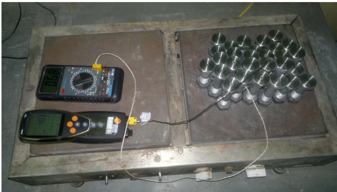
Slika 3.28: Predgrevanje zavrtnjeva pre ugradnje lepka i mernih traka
