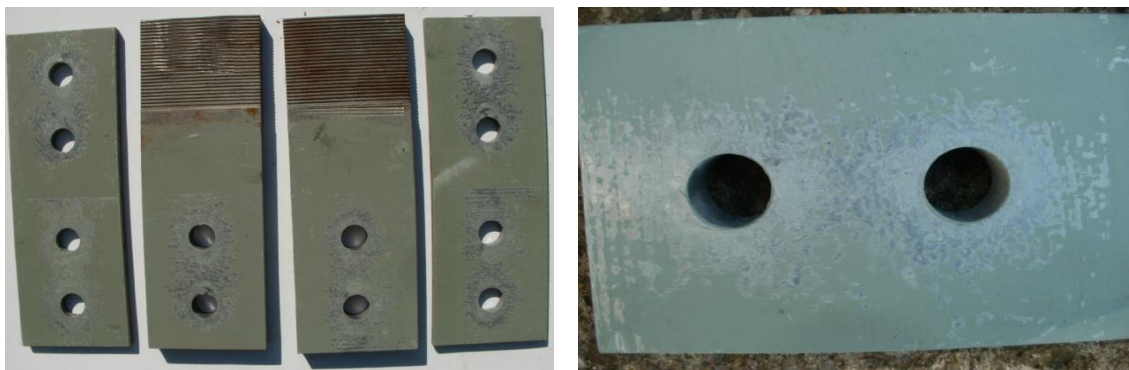
Slika A.5: Epruvete pritegnute zavrtnjevima M20 – izgled nakon ispitivanja
