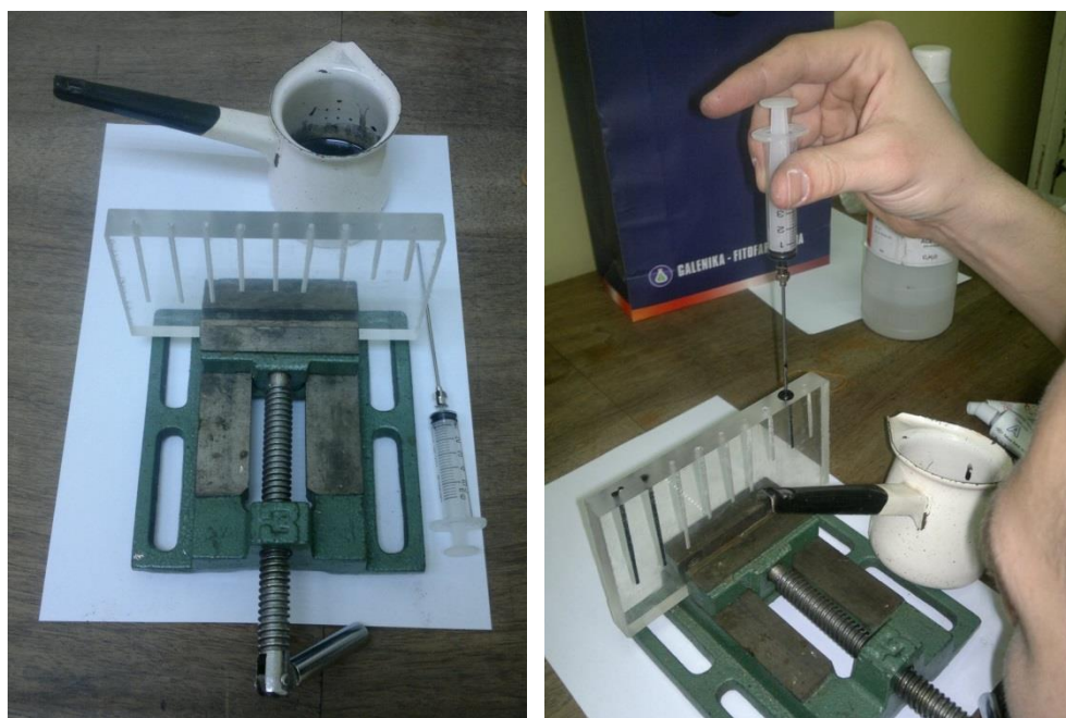
Slika 3.30: Probna ugradnja lepka u rupe izbušene u komadu pleksiglasa
