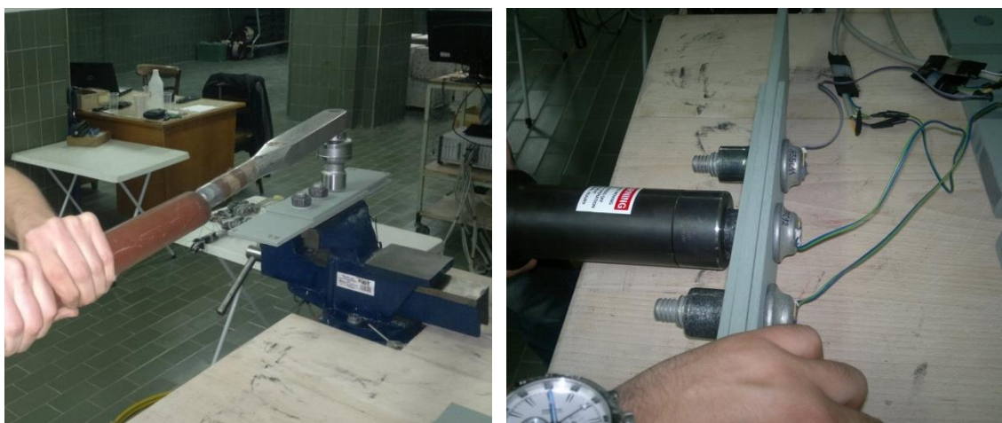
Slika 3.47: Ugradnja zavrtnjeva u uzorke
