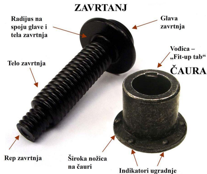
Slika 2.3: Spojno sredstvo sistema „Huck BobTail“
