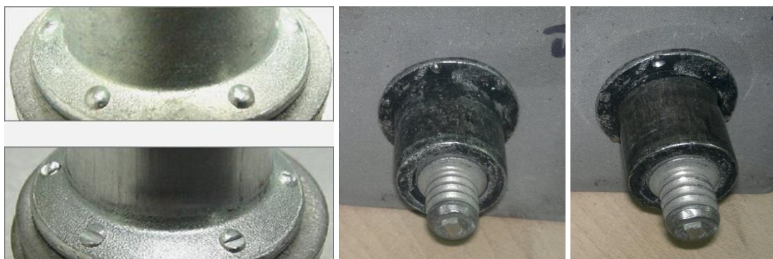
Slika 2.9: Indikatori ugradnje HBT zavrtnja na nožici čaure pre i posle ugradnje zavrtnja
