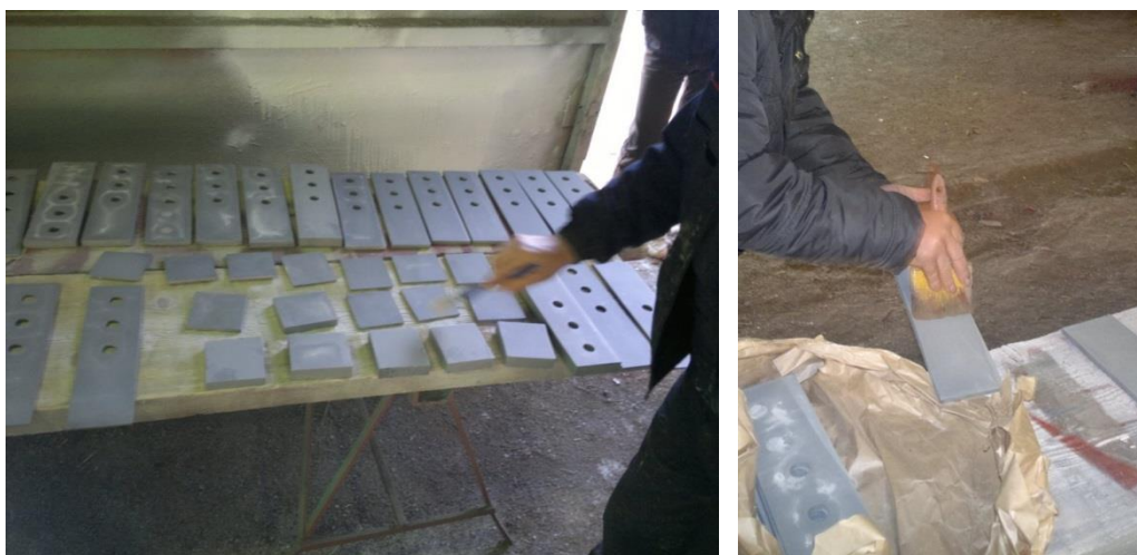
Slika 3.15: Čišćenje čeličnih ploča nakon peskarenja
