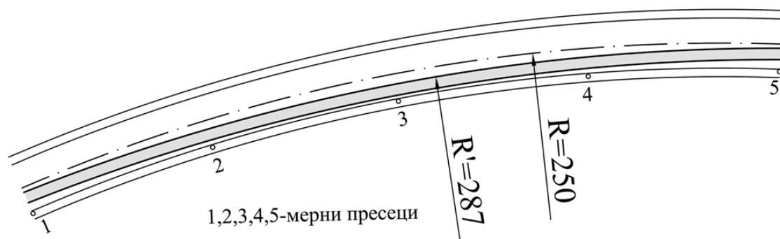
Слика 5.30 Најзаступљенија гранична возена трајекторија на делу кружног лука – мерење „изнутра“
