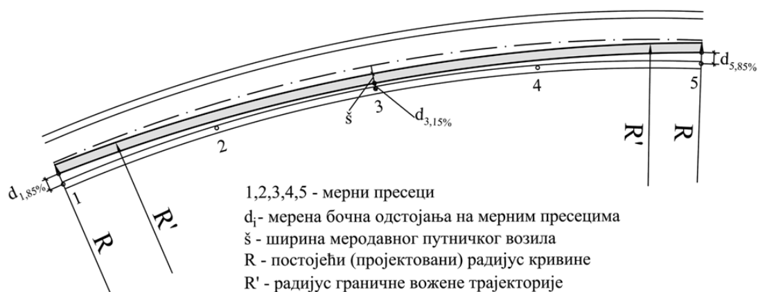
Слика 5.5 Поступак за одређивање радијуса граничне вожене трајекторије
