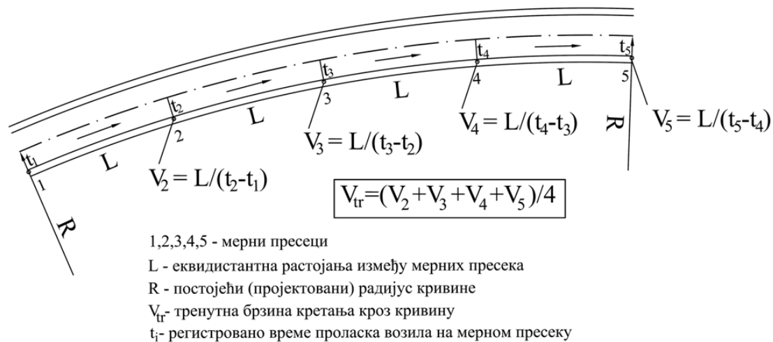
Слика 5.3 Поступак за одређивање тренутне брзине кретања возила
