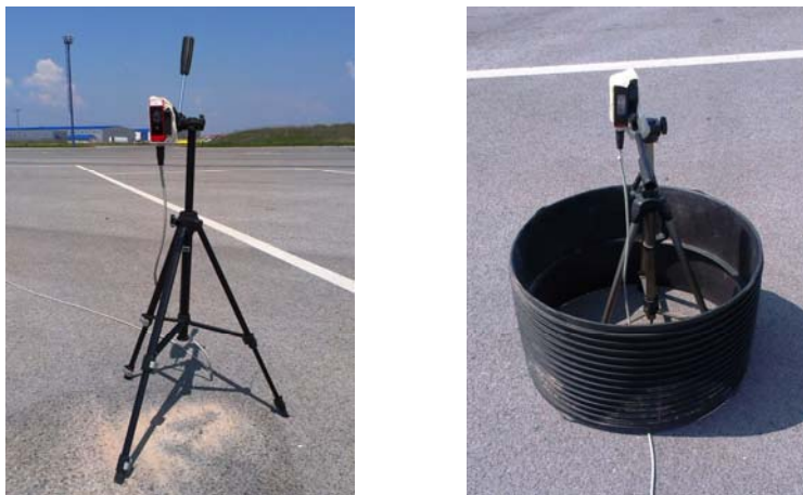
Слика 5.12 Начин постављања и заштите сензора
