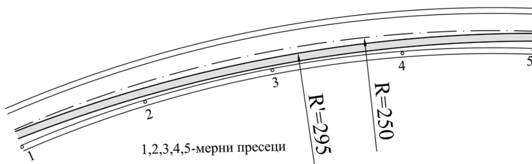
Слика 5.29 Најзаступљенија гранична возена трајекторија на делу кружног лука
