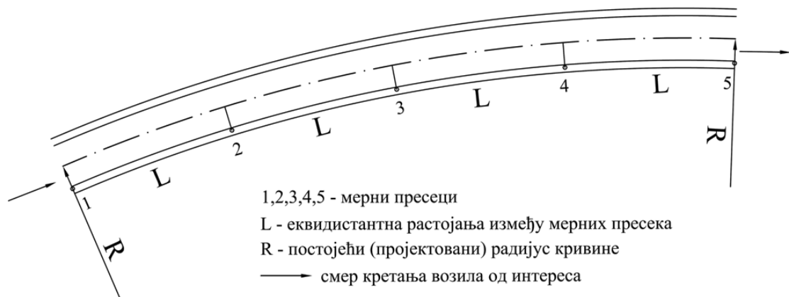
Слика 5.2 Положај мерних пресека у кривини
