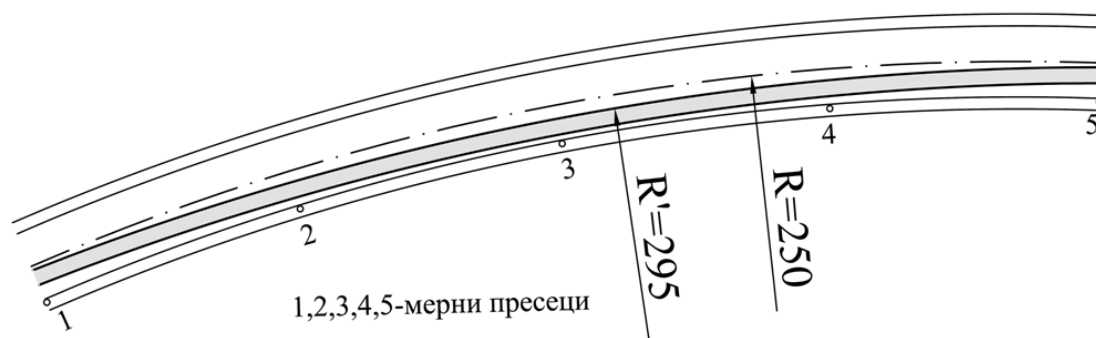
Слика 5.32 Најзаступљенија гранична возена трајекторија на делу кружног лука за мерно место 1
