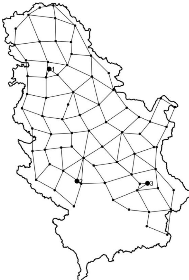
Слика 6.4: Распоред тачака у којима су одређена убрзања применом апсолутног гравиметра и полигони нове основне гравиметријске мреже Србије
