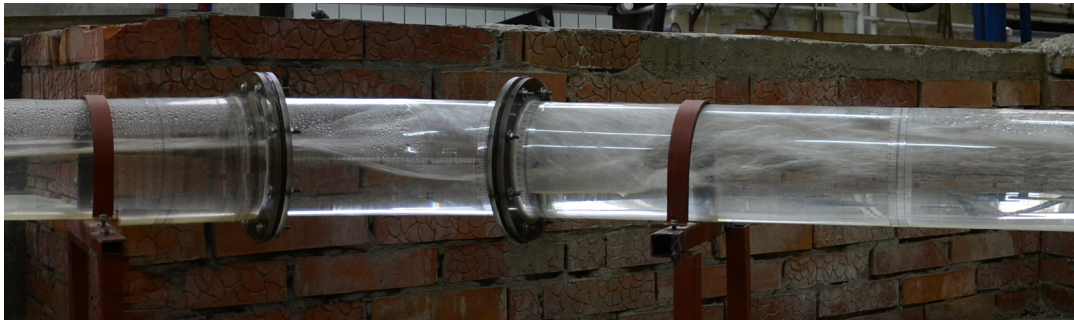
Слика 5.2: Течење са окретањем млаза у кривини [36]
