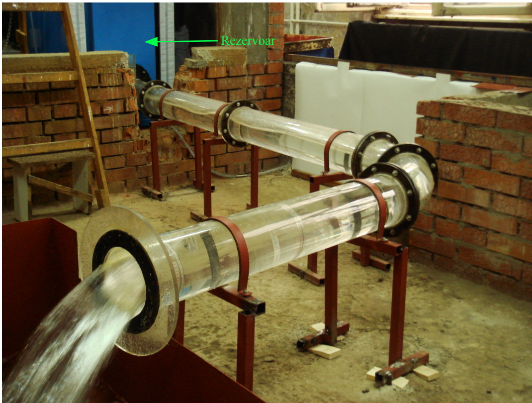
Слика 5.5: Фотографија физичког модела закривљеног проводника [36]
