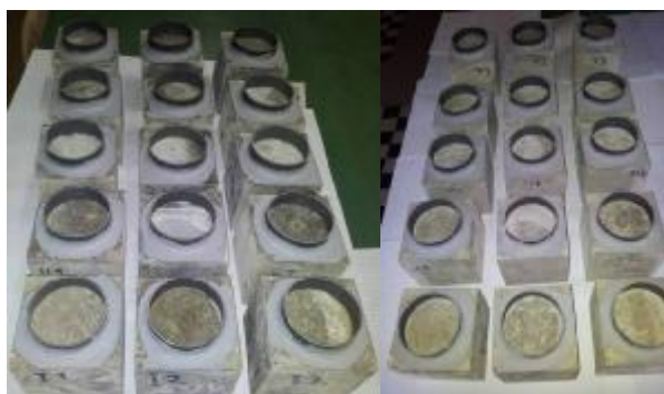
Slika 7.3 Uzorci pre (levo) i posle (desno) izlaganja dejstvu mraza i soli
