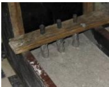
Slika 3.9 Samozbijajući beton bez efekta blokiranja pri testiranju L-boksom
