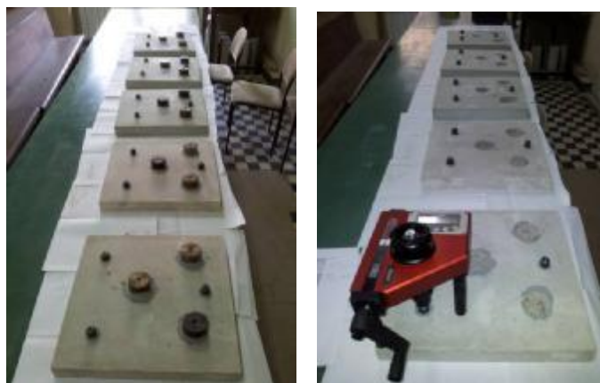
Slika 4.9 Zalepljeni pečati u testu "pull-off" (levo) i dispozicija ispitivanja sa "isčupanim" pečatima sa uzorka (desno)
