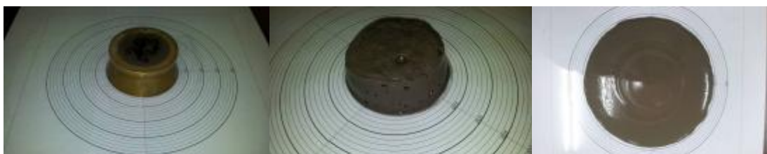
Slika 6.13 Test malog konusa za definisanje ponašanja pasti sa letećim pepelom
