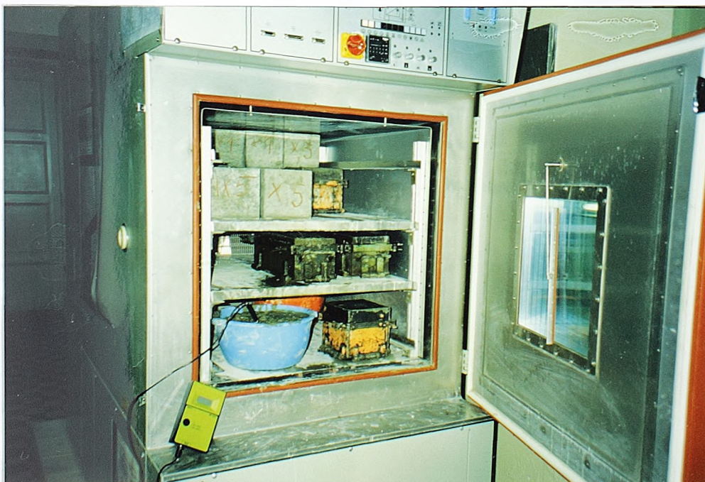
Sl. 5.8 Klima komora sa uzorcima betona i merenjem temperature
