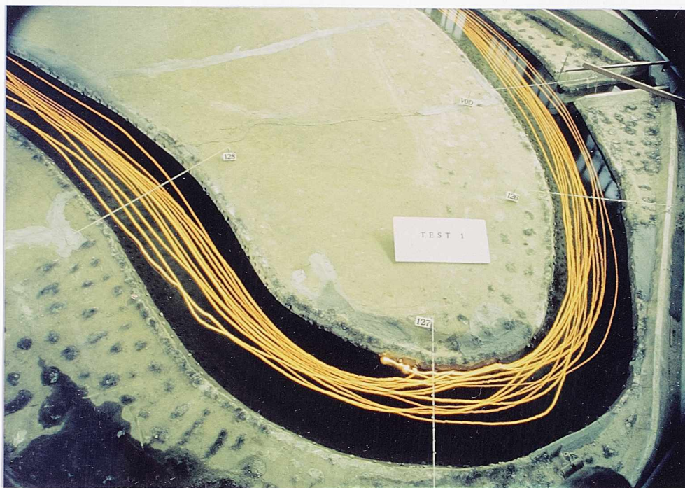
Slika 5.2: Fotografija trajektorija plovaka na hidrauličkom modelu rečne krivine (autori: Miljan Djurić i Radomir Kapor).
