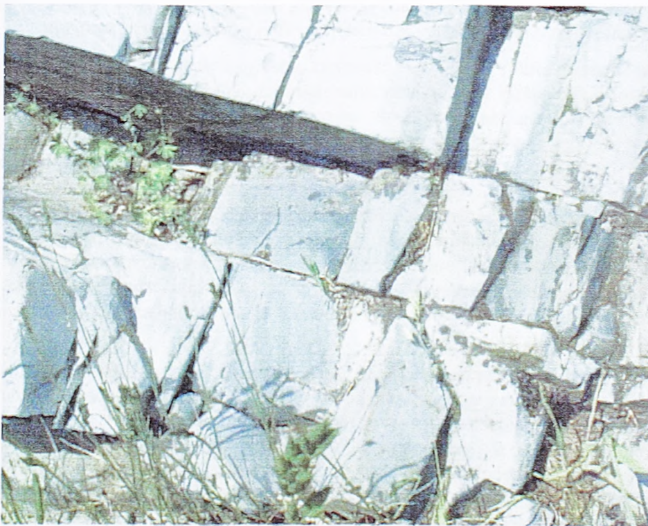
Слика 1.2: Преградно место Орловача на реци Велики Рзав - пукотине лучења у дијабазима -
