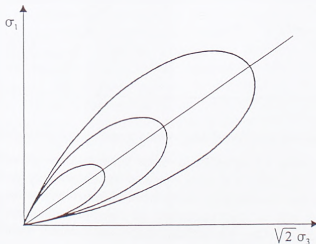
Слика 3.11: Lade -ов услов течења у простору главних напона
