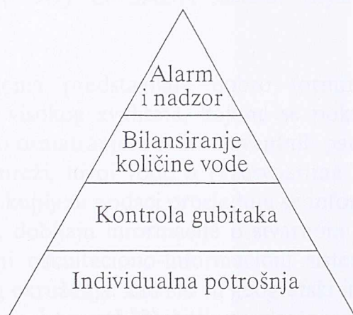
Slika 5.6: Organizacija sistema monitoringa vodovodnih sistema
