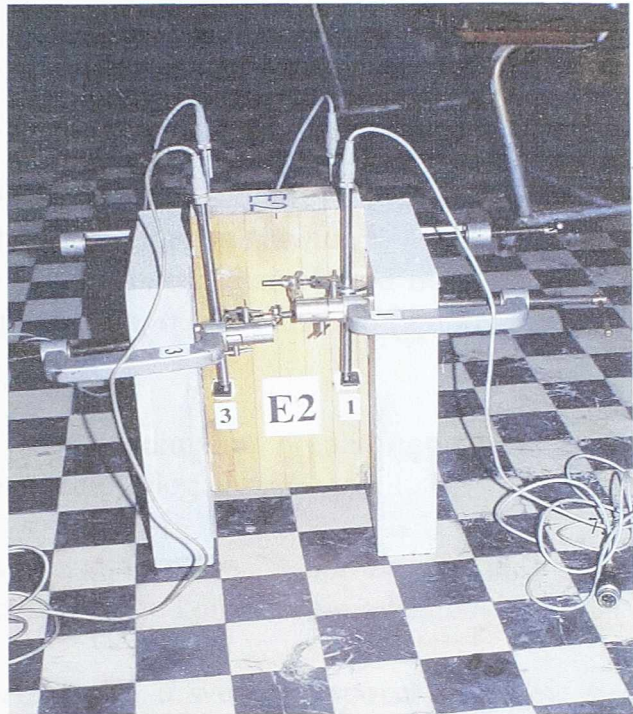
Slika 3.15 - Položaj induktivnih ugibomera na modelu
