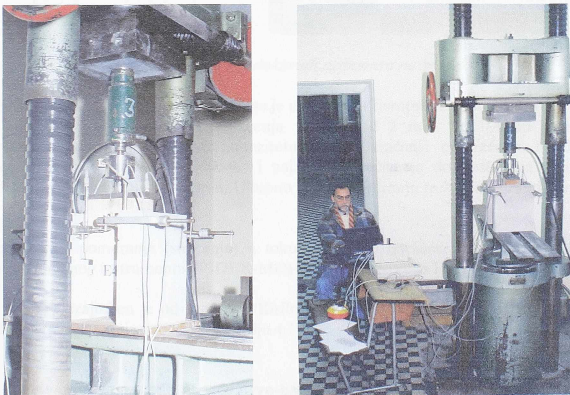
Slika 3.14 - Ispitivanje modela za određivanje modula pomerljivosti veze drvo-beton
