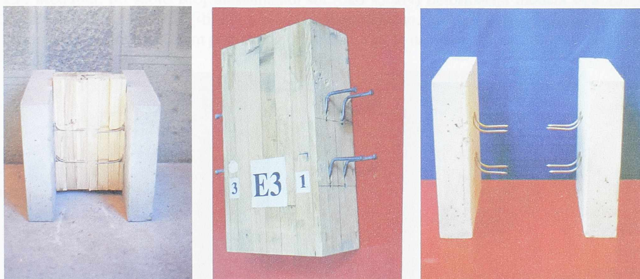
a) b) c) Slika 4.6 - Izgled uzorka - Tip EP nakon ispitivanja (a). Drveni (b) i betonski (c) deo uzorka, sa deformisanim spojnim sredstvima - ekserima
