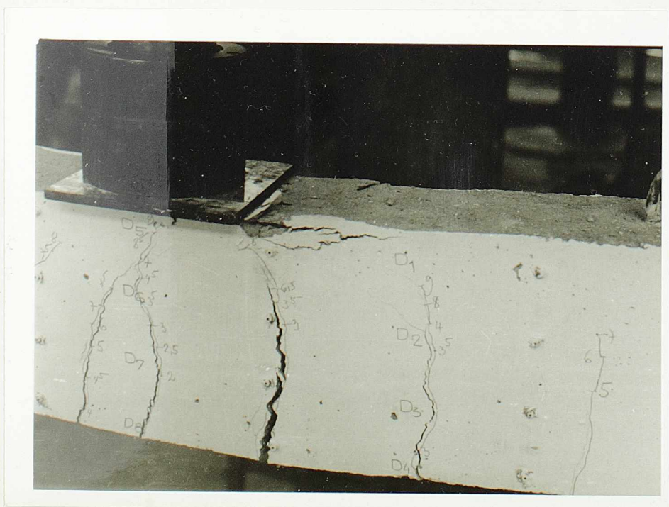
Sl. 11.6.- Lom betona u polju
